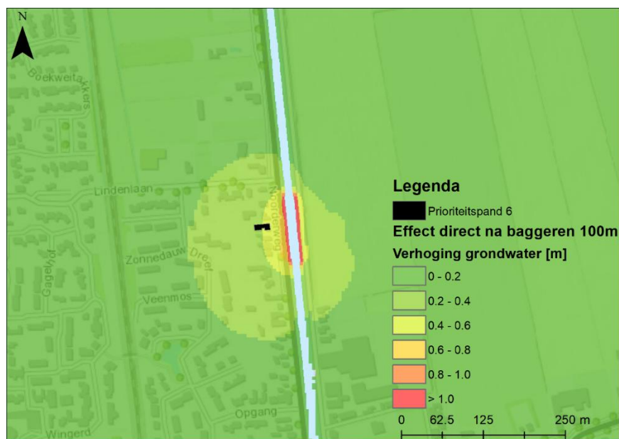
Figuur 4.22 Het effect van bodemweerstand verlaging van een strook van 100 meter
