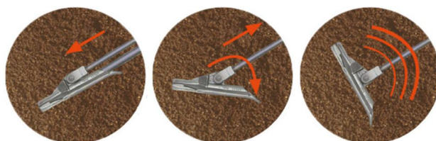
Figuur 6.6 schematisch overzicht van de werking van een klapanker
