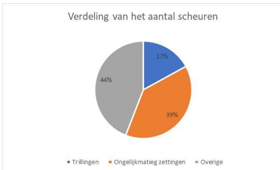
Figuur 3.1 Nadere verdeling van het totaal aantal scheuren over de oorzaken (26 panden die representatief geacht worden voor woningen)
